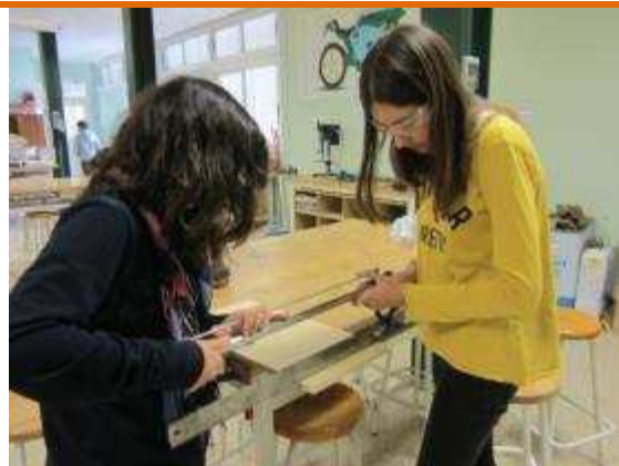
Rebaixar de banda a banda els 10 primers solcs uns 3 mm de fondària.
