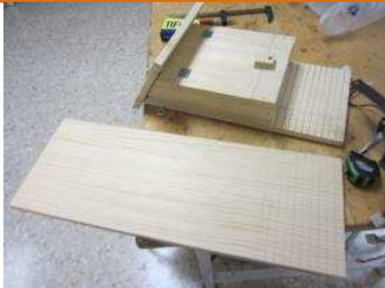
Tallar fusta de 214 mm x 40 mm x 18 mm per a l'entrada dels ratapatxets.
