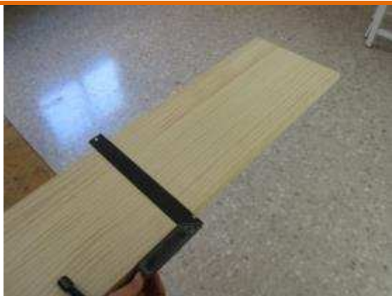
Tallar fusta de 500 mm x 250 mm x 18 mm per a la base de la caixa de ratapatxets.
