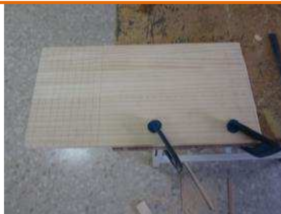
Tallar fusta de 190 mm x 300 mm x 18 mm per a la teulada.
