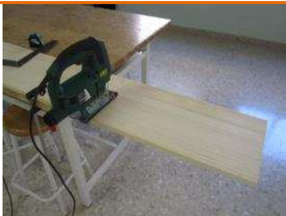
Tallar fusta de 300 mm x 150 mm x 18 mm per a la part frontal.
