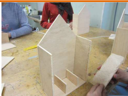
Posar els separadors a una distància de 5 cm dels costats.
