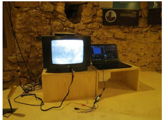
Per fer el seguiment s'ha disposat d'una càmera de vídeo instal·lada prèviament al niu amb una font d'alimentació de 12V, un televisor, una placa controladora de vídeo i un ordinador.
