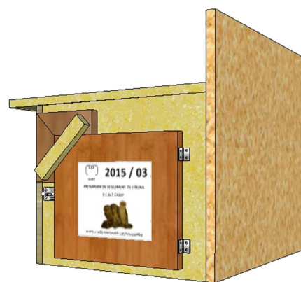
Vista frontal amb peça 15x30x1,8 cm per facilitar l'entrada a les òlibes.
