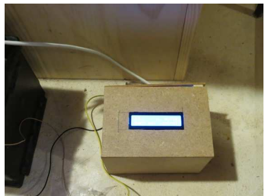
Integrar display i electrònica en una caixa.
